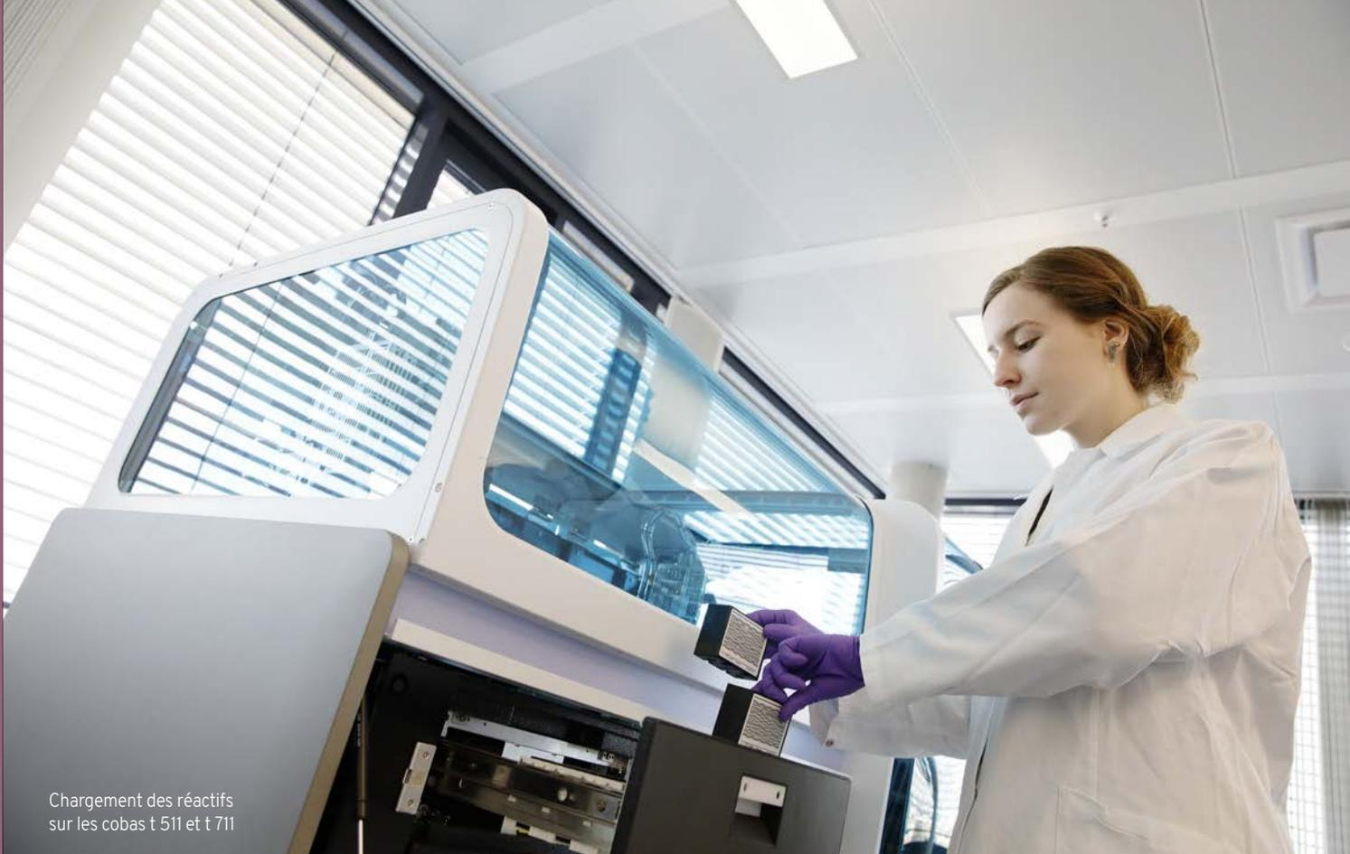
Chargement des réactifs sur les cobas t 511 et t 711
